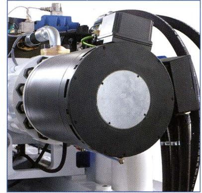
Motore elettrico Torque per la plastificazione
