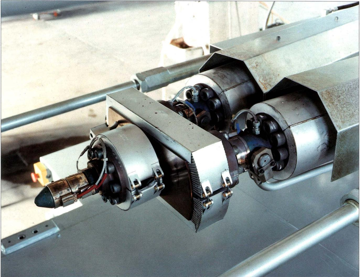
**Sistema di iniezione bicilindrico (brevettato)**
