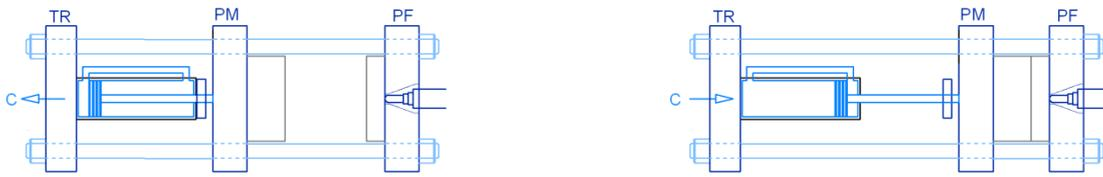
CHIUSURA IDRAULICA SULLE COLONNE
