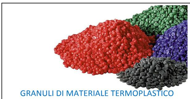
Per trasformare il materiale termoplastico che viene prodotto in forma di GRANULI tramite la tecnologia dello stampaggio ad iniezione si utilizza una PRESSA AD INIEZIONE ed uno STAMPO
